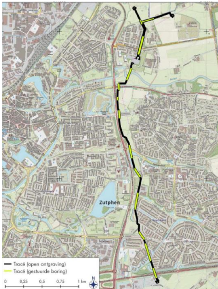
Figuur 1: Weergave toekomstige ondergrondse situatie
